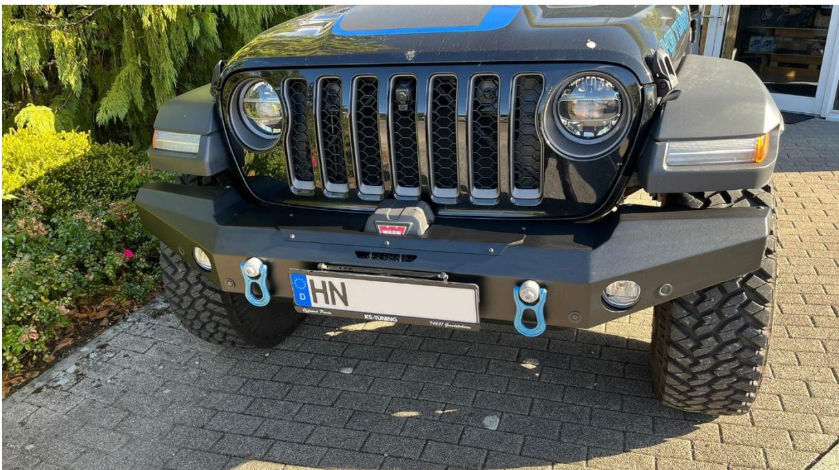
Fertig Angebaute NSR Frontstoßstange mit Windeneinbausatz, Windenabdeckung, Klappkennzeichenhalter, PDC Einbausatz, Berge Schäkel [Lack individuell] und Unterfahrschutz.
